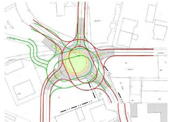
Abb. 6: Variantenprüfung Kreisverkehrsanlage Grafenauer Straße, aus [12]
