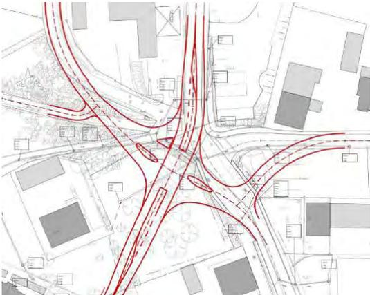
Abb. 8: Variantenprüfung Linksabbiegespur Grafenauer Straße, aus [12]
