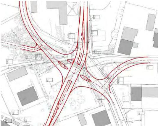
Abb. 8: Variantenprüfung Linksabbiegespur Grafenauer Straße, aus [12]
